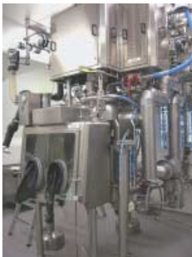
Abb. 4: Boehringer Ingelheim, Biberach. Isolator in der umgebauten Produktion für hochwirksame Substanzen.
